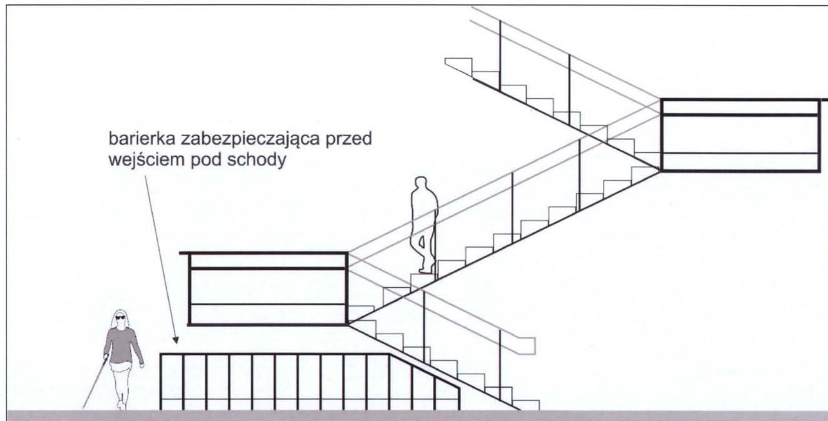
Rysunek 1.8. Zabezpieczenie przeszkód na ciągu pieszym (dopuszcza się inne rozwiązania niż bariera – zieleńce, mała architektura etc.).
