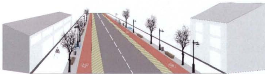
Rysunek 1.1. Preferowany, przykładowy podział funkcjonalny pasa drogowego z czytelnym rozdzieleniem części pieszej, rowerowej, jezdnej i pasa technicznego z małą architekturą
